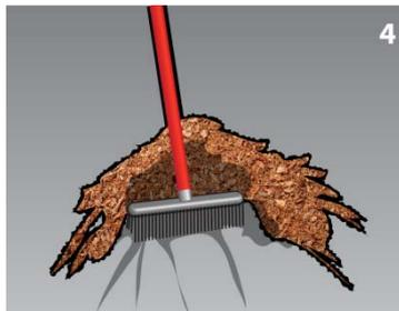
**4** Подождать, пока абсорбент впитает в себя нефтепродукт – его цвет изменится со светло-коричневого на темно-коричневый, затем собрать пропитанный абсорбент с помощью совка и щетки с жесткой щетиной.
